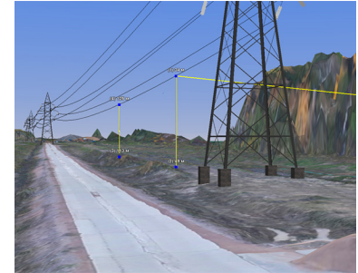
La divergencia entre los datos obtenidos con la tecnología Geoscan y GIS Sputnik LTE (restauración de cables a través del método fotogramétrico) y los resultados de escaneo láser fue 10 cm
